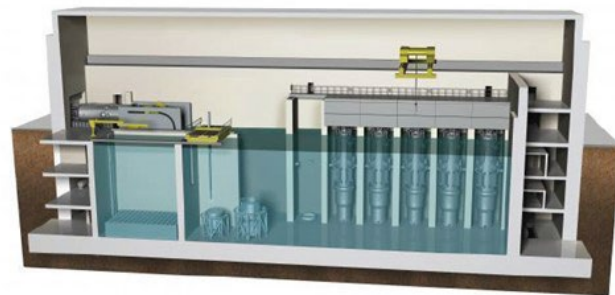
미국 뉴스케일의 SMR 모형도. 하나의 격납용 건물 안에 복수의 원자로가 설치돼 규제 마련에 큰 난점으로 떠오를 전망이다.
